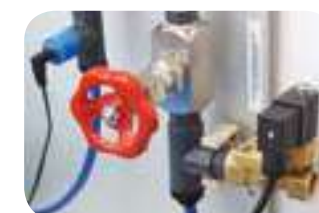
Valvola a spillo inox ed elettrovalvola di flusso.
