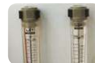
Flussimetri per la lettura di concentrato e permeato.
